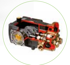
Pompe radiale à vilebrequin avec tête de pompe en laiton, pistons en céramique et valves en acier inoxydable
